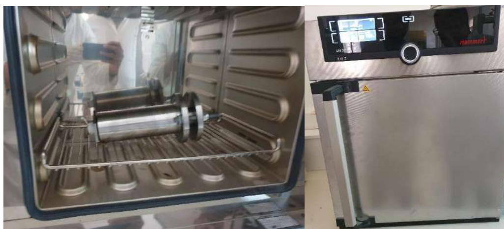
Figure IV-35 Mise en place de l'échantillon dans une étuve
