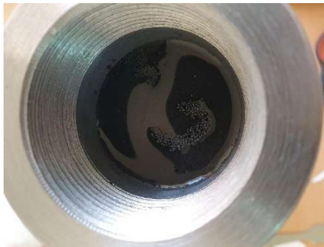
Figure IV-33 Mise en place de l'échantillon de proppant et de fluide de fracturation dans la cellule de confinement.
