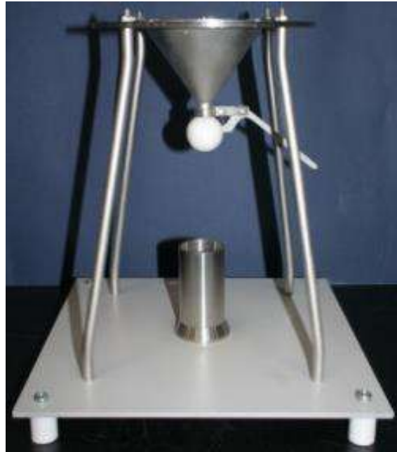
Figure IV-29 Dispositif de mesure de la densité apparente ISO
