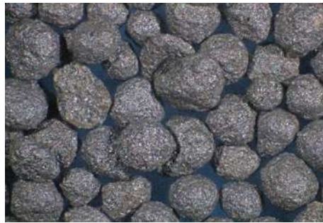
Figure I-5 Bauxite frittée (par Sintex Agents de soutènements) (Fitzgibbon, J.J, 1984)
