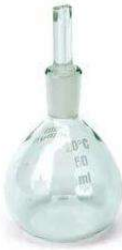
Figure IV-31 ISO 13503-2: 25 ml pycnomètres
