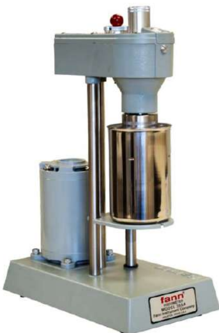
Figure IV-20 Viscosimètre modèle 35SA
