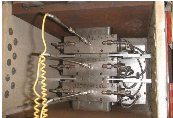
Figure I-18 Appareil d'essai de la conductivité de la rupture à long terme chargé de trois cellules à écoulement linéaire API (par Carbo Ceramics Inc.)
