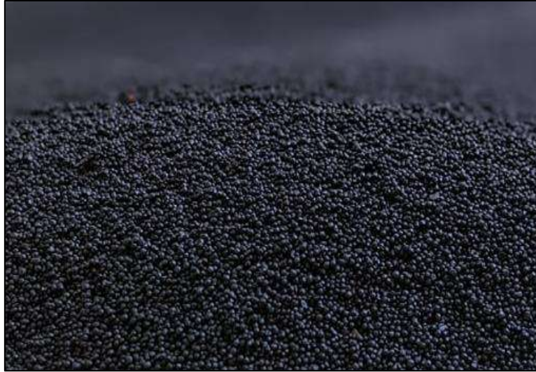
Figure IV-2 Agent de soutènement en Bauxite de taille 20/40 utilisé dans les expériences
