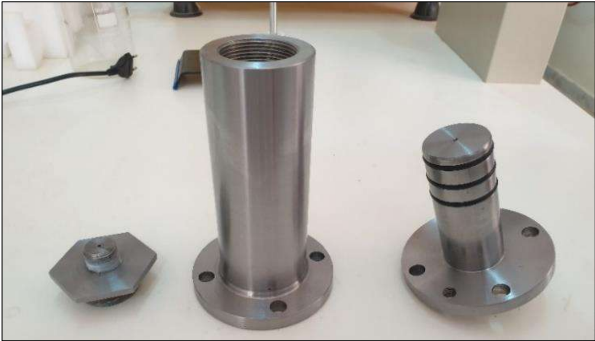
Figure IV-11 Composants du piston fabriqués
