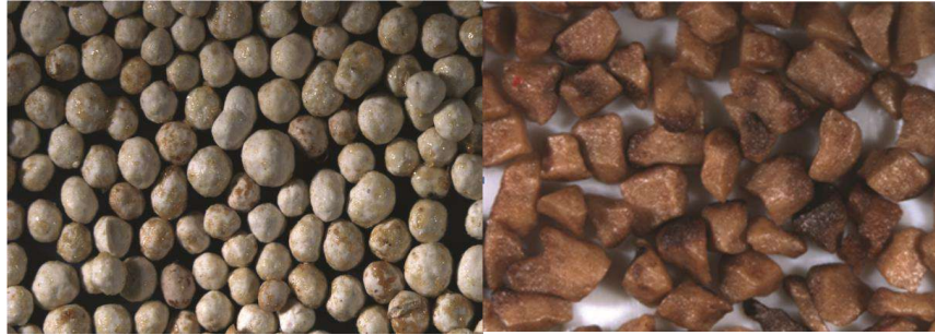
Figure I-12 Agents de soutènement ultralégers ( \gamma_{prop} = 2,02 & \gamma_{prop} = 1,25 ) fabriqués à partir de particules céramiques poreuses enrobées de résine (par BJ Services Company) (Aboud, R.S et al, 2018).
