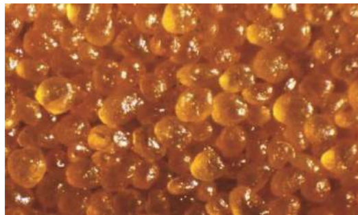
Figure I-11 Agents de soutènement enrobé de résine durcissable (par Santrol)
