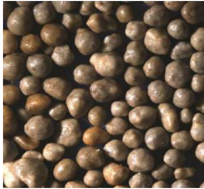
Figure I-10 Agents de soutènement pré-durci enrobé de résine (par Santrol)
