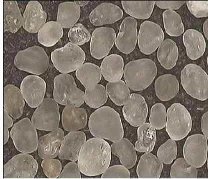
Figure I-3 Grains de sable d'Ottawa (Assem, A.I et al, 2017)
