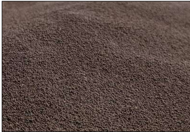
Figure IV-3 Agent de soutènement en Bauxite de taille 20/40 utilisé dans les expériences
