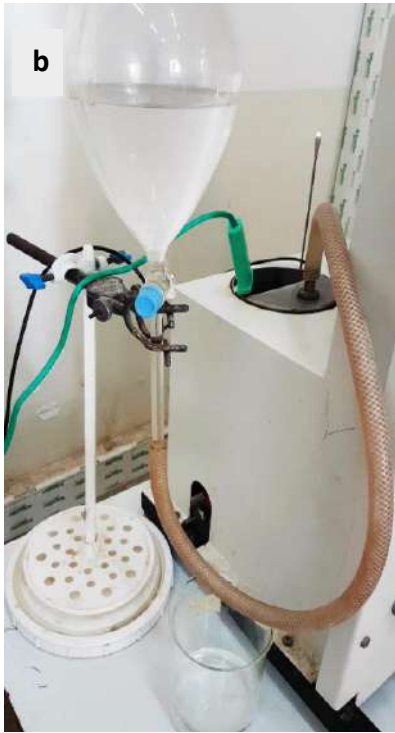
Figure II-7 : a. Image de face de l'appareil de fluidisation, b. image latérale de l'appareil de fluidisation montrant le réservoir d'eau et l'ampoule de décantation
