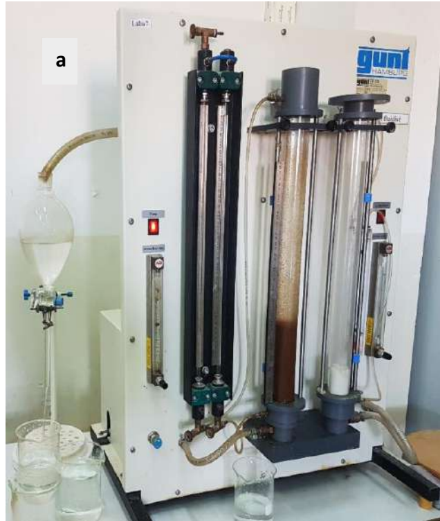
Figure II-7 : a. Image de face de l'appareil de fluidisation, b. image latérale de l'appareil de fluidisation montrant le réservoir d'eau et l'ampoule de décantation
