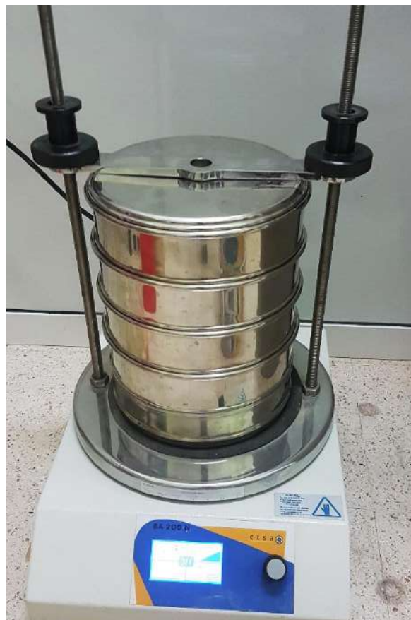
Figure II-1 Tamiseuse électromagnétique utilisé pour l’analyse du sol.
