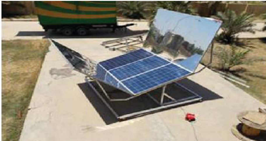
Figure I.39. Concentrateur PV utilisé avec le traqueur bi-axial [55]
