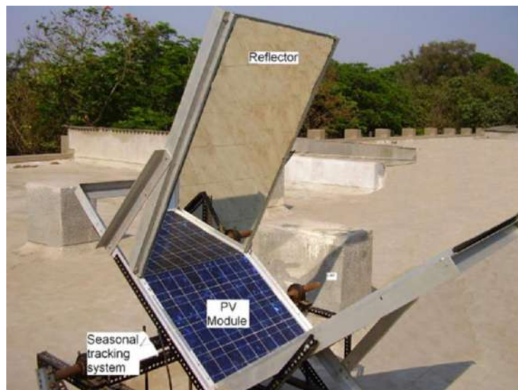
Figure I.38. Concentrateur PV utilisé avec le traqueur saisonnier [54]
