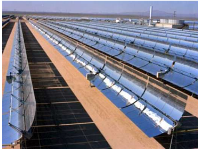
Figure I.11. Systèmes à concentrateurs cylindro-paraboliques
