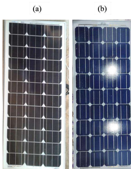
Figure A.1. Vue de face des modules PV utilisés (a) Dimel 50 Wp et (b) Eurosolaire 47.1 Wp
