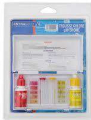
Figure II.9 : Matériel de contrôle de qualité de l'eau ( Chlore libre, pH, Brome)
