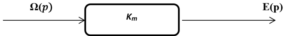
Figure III.12 : Schéma bloc de vitesse de rotation en fonction de la force Contre électromotrice.
