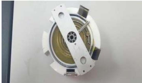
**Figure II-15:** Potentiomètre [07]
