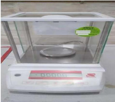
**Figure II-16** : Balance de précision
