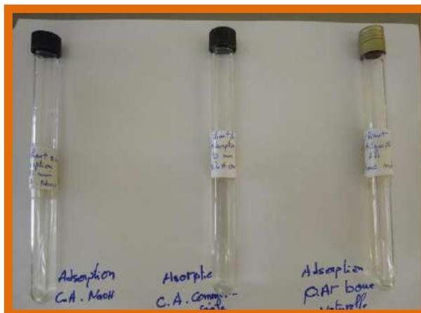
**Figure V.5 : Échantillons des eaux huileuses traitées par adsorption sur la boue naturelle, CA-NaOH et charbon actif commercial après un contact de 80 min**
