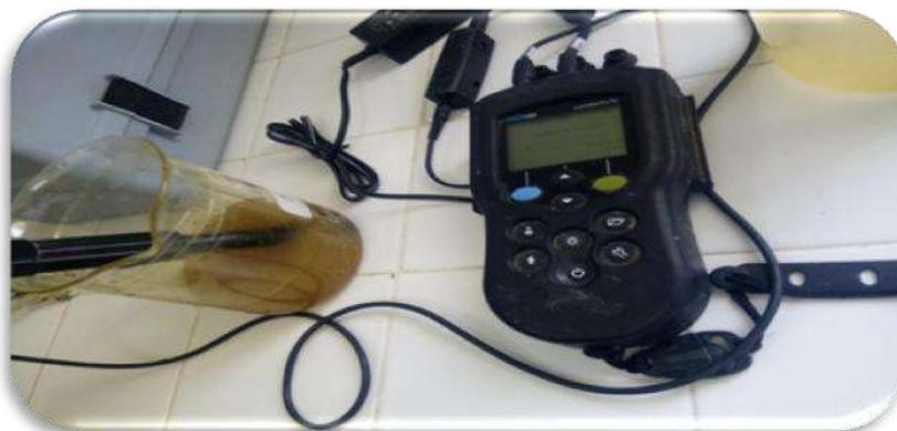
**Figure IV.4 : Conductimètre type HACH.**
