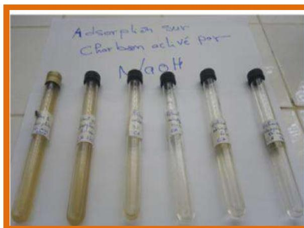
**Figure V.3 : Échantillons des eaux huileuses traitées par adsorption sur CA-NaOH-15**
