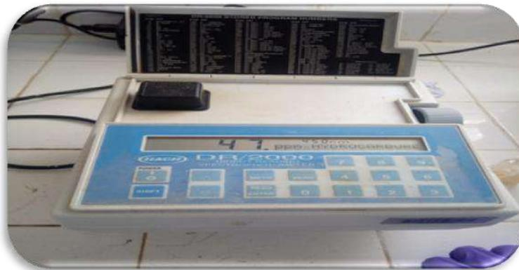
**Figure IV.3 : Spectrophotomètre DR/2000.**
