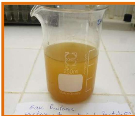
Figure IV.5 : Échantillon de l'eau huileuse brute
