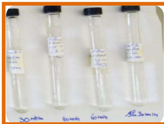
**Figure V.4 : Échantillons des eaux huileuses traitées par adsorption sur charbon actif commercial**
