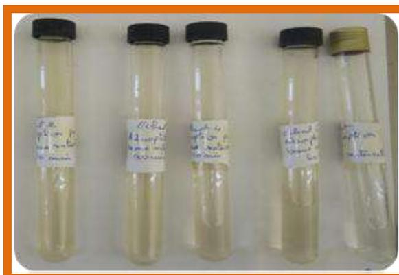
**Figure V.1 : Échantillons des eaux huileuses traitées par adsorption sur boue naturelle**
