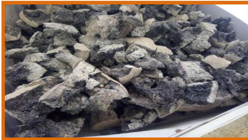
**Figure IV.6 : Boues d'épuration sèches**
