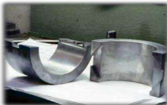
Figure II.11: Paliers radiaux (a: palier radial lisse ; b: palier radial a patins)
