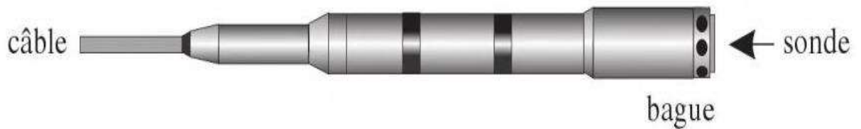
Figure II.22 : Pied de câble et point de rupture
