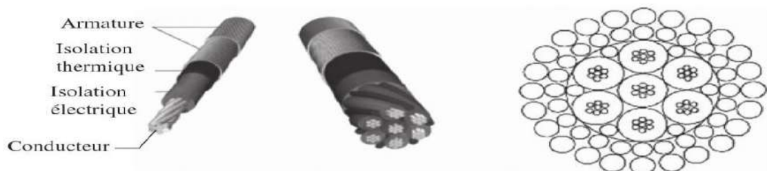
Figure II.21 : Schéma de câble logging et coupe d'une section et différents torons de fils.
