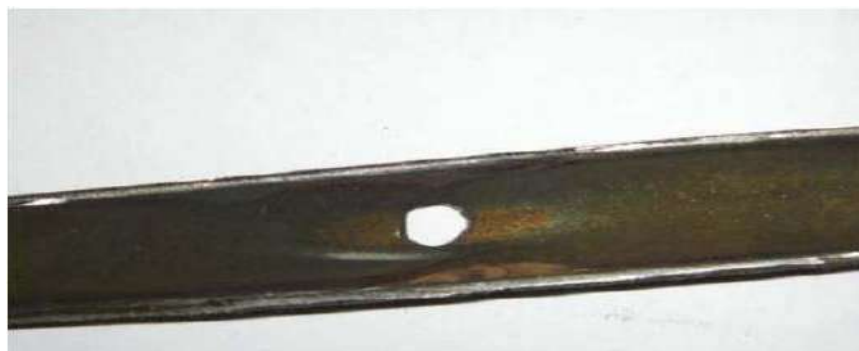
Figure I.4 : Corrosion interne causée par la perforation du tube
