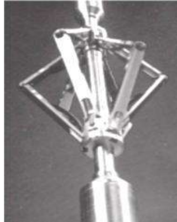
Figure II.20 : Premiers dispositifs de centrage sur les sondes de diagraphies
