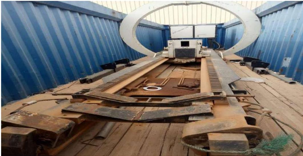
**Figure III.15 : Extracteur faisceau.**
