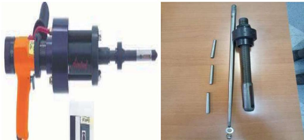
**Figure III.14 : Outil de dudgeonnage des tubes.**
