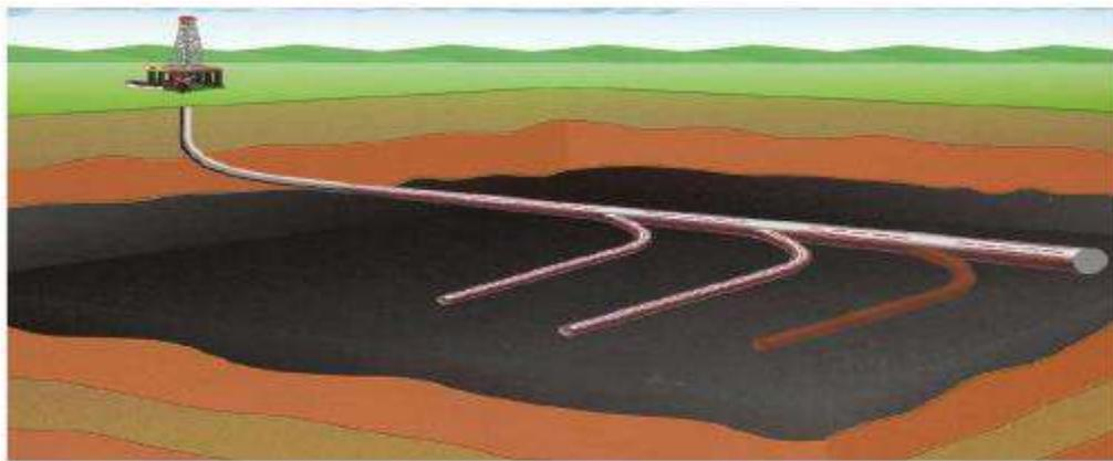
Figure 2-3 : puits multilatéraux en arête de poisson.
