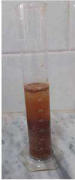
Photo III- 4 l'essai de masse volumique apparente
