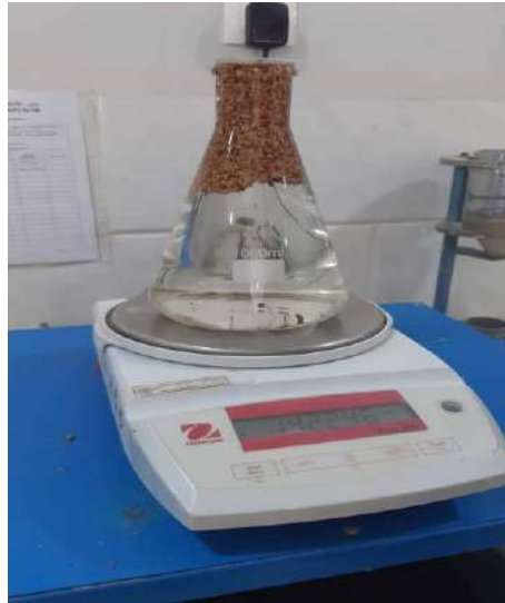
Photo III- 5 l'essai de masse volumique absolue.
