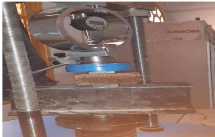
Photo III- 9 Les étapes du principe de la compression
