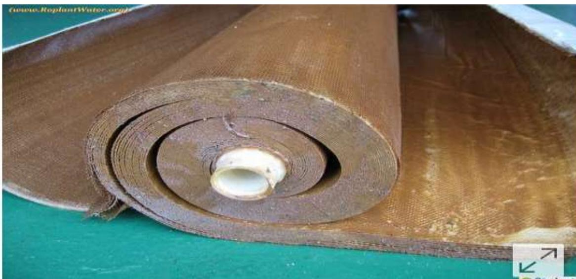
Figure IV. 4: Membrane de nanofiltration pour une usine de désalinisation [18].
