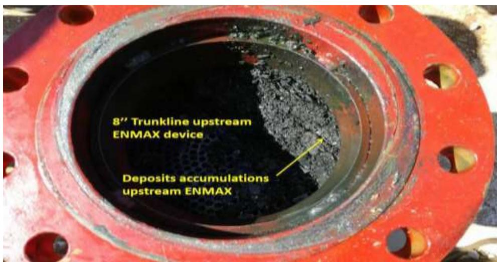
Figure III. 10: Accumulation de dépôts dans l'Enmax en amont. [13]
