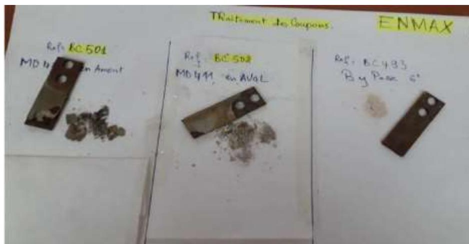
Figure III. 21 : Analyse des coupons de scale en amont en aval ENMAX sur le puits MD-411.
