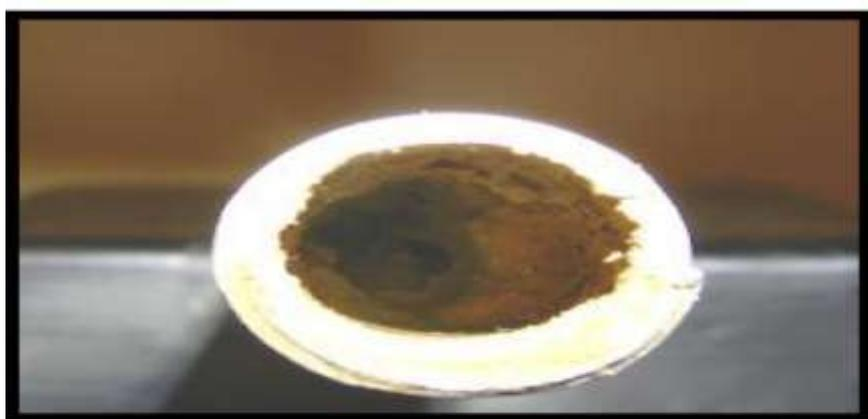
Figure I. 8 : Dépôt de sel contient le  $SrSO_4$ .
