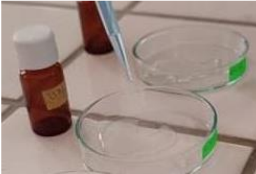
Figure 3 : Hydrolyse acide partielle des polysaccharides d'Urginea noctiflora par l'acide tri-fluoro-acétique (TFA).
