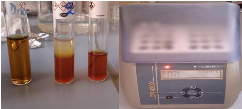
Figure : tubes DCO avant et après oxydation dans un bloc chauffant
