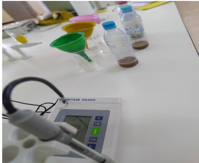
Photo 4: mesure le pH du sol par la méthode électrométrique (pH mètre).
