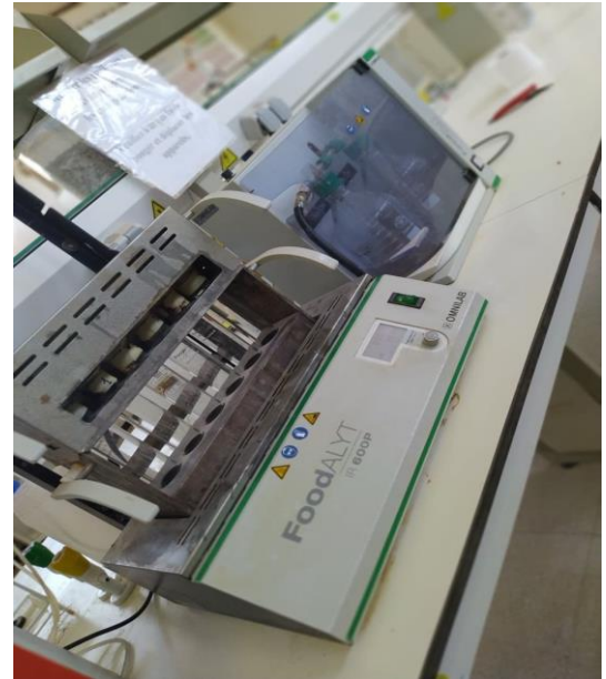
Photo 7: Digesteur à étape minéralisation
