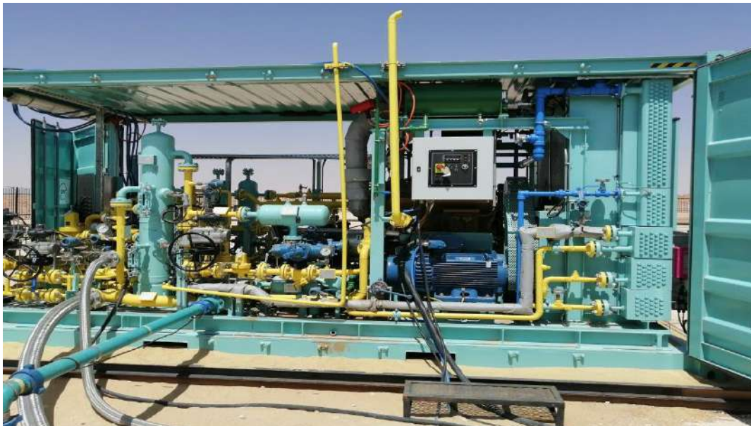
Figure I.11: Unité de compression de système Auto-Boost
