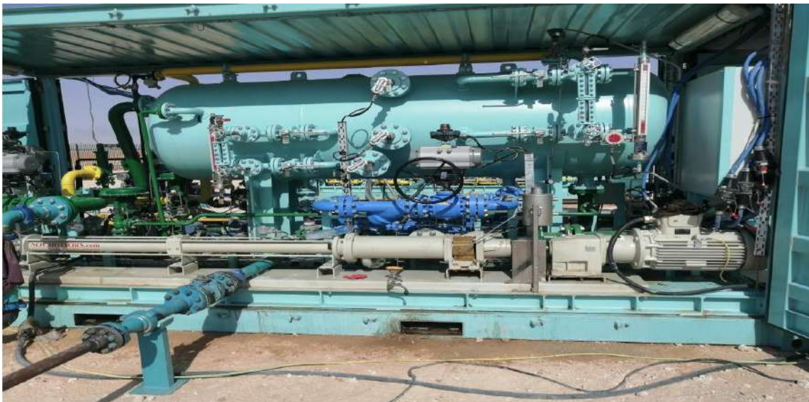
Figure I.10 : Unité de séparation du système Auto-Boost
