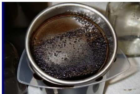
Figure. IV.1: Sludges asphaltiques induit par acide. [20]
