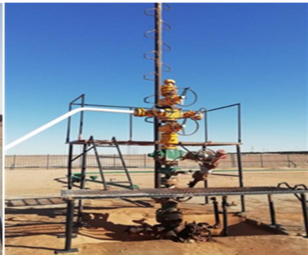
Figure.III.2.Configuration d'un puits producteur d'huile gaz lift OKJ#32 [7]
