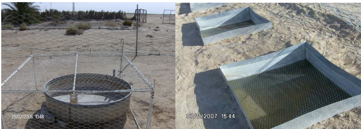
Figure 2. Bacs d'évaporation Classe « A » et Colorado
