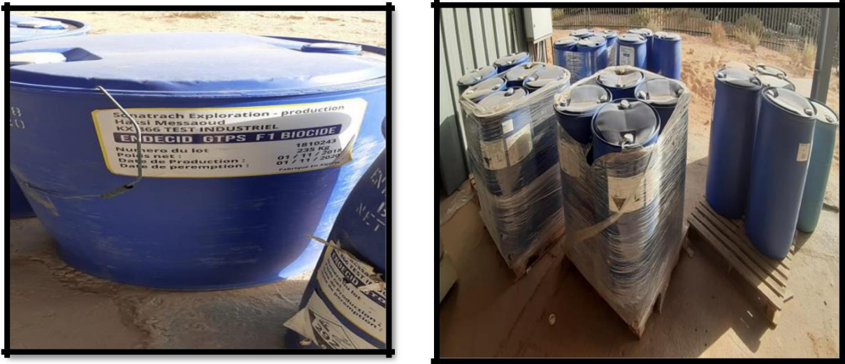
Figure III.4.:inhibiteur de corrosion et Biocide utilisé dans la station Z14 HMD
