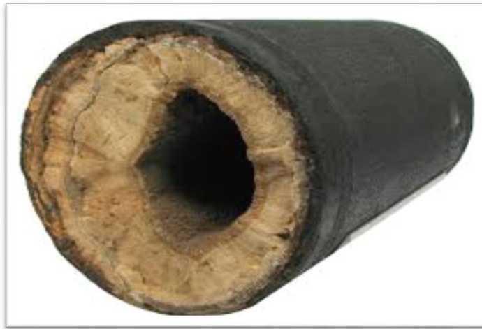
Figure II.9: dépôt de sulfate de calcium dans un tubing [1]
