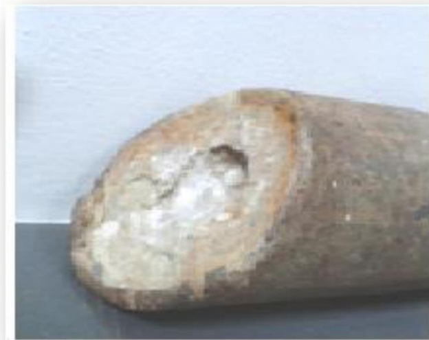
Figure II.11 : dépôts de sulfate de strontium dans un tubing [1]
