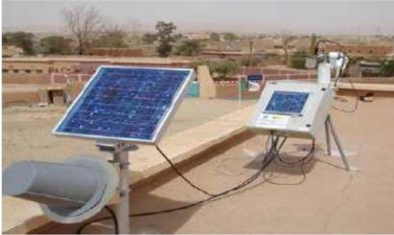
الشكل (III-7): أدوات قياس سمك الضوئي للهباء الجوي [4]
