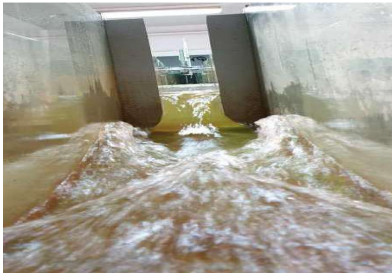
Photo1.4. dispositif de mesurage des débits volumiques
