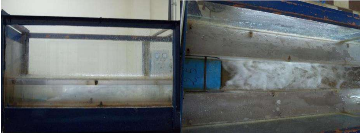
Photo 2.10. écoulement formé pour F_1=5,58 ; s=6 cm; L_j=103 cm; h_2=15,8 cm ; h_1=2,5 cm
