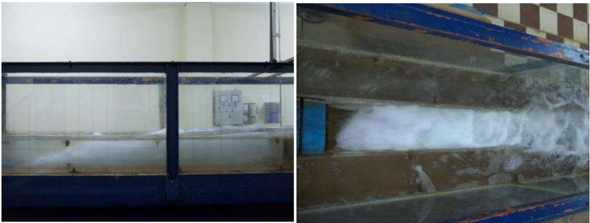
Photo 2.11 écoulement formé pour F_1=8,24 ; s=15 cm; L_j=186 cm; h_2=24,9 cm ; h_1=2,5 cm
