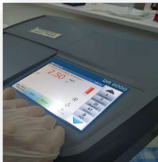
Figure V-8: Analyse des Fluor par Spectrophotomètre
