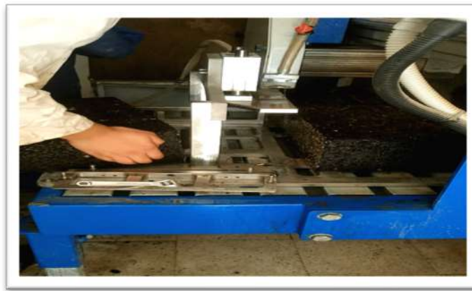
Photo X.2. Opération de coupage d'une plaque.
