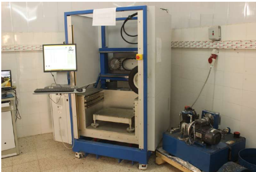
Photo IX.4. Table de compactage (compacteur à roue).
