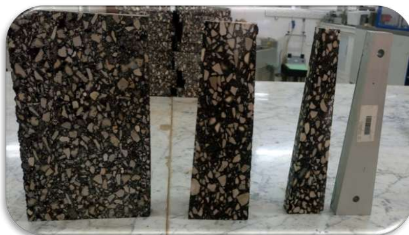
Photo X.3. Préparation d'éprouvette trapézoïdale à partir d'une plaque de 25 mm d'épaisseur.
