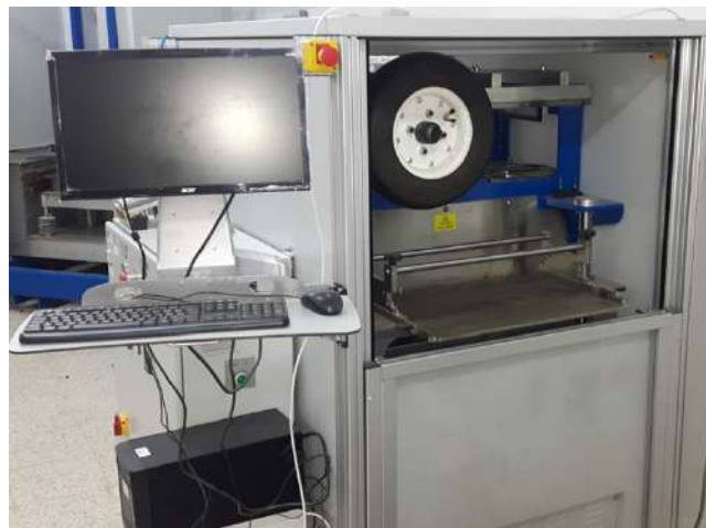
Photo IX.3. Appareil de l'essai d'orniérage.
