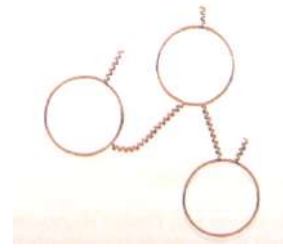
Étape 03 et 04 : domaine de polystyrène gonflé par le bitume et dispersion ultérieure par cisaillement
