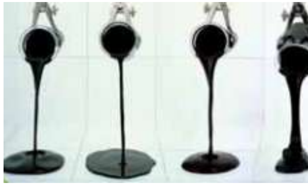
Photo II.1. Quatre échantillons de bitume écoulent en différentes manières sous les mêmes conditions [9].
