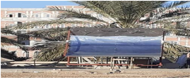
الشكل (1-3): صورة لنموذج المركز الشمسي الأسطواني الـ (PTC).
