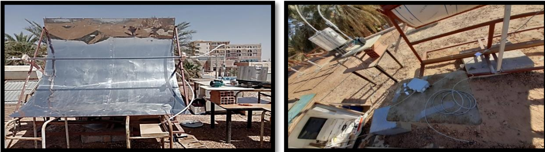
الشكل (3-6): صورة للتركيب نموذج المركز الشمسي الأسطواني الـ (PTC).
