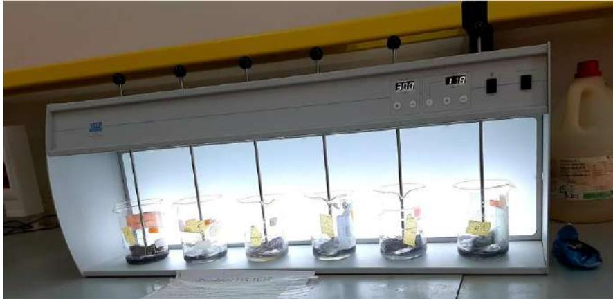
**Figure III-12:** Appareille de JAR TEST
