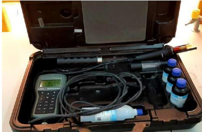
**Figure III-16: Multiparamètre HAANA**
