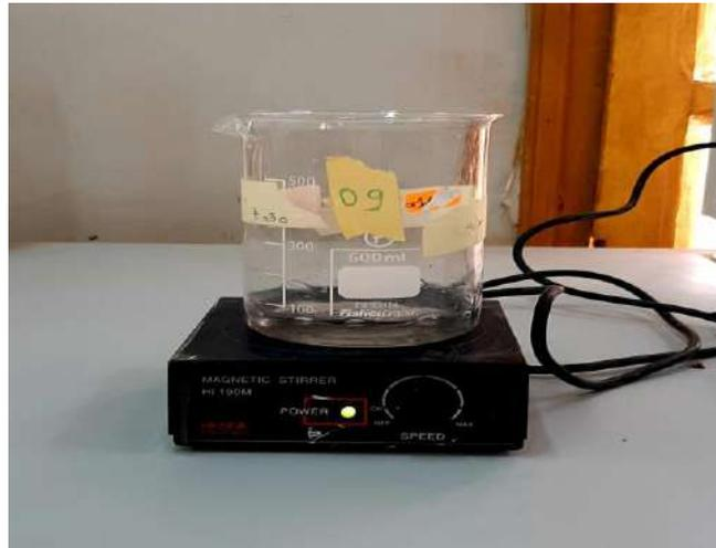
**Figure III-14:** Agitateur magnétique
