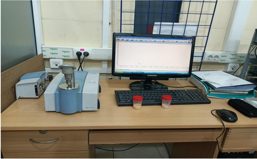
الشكل (II-19): جهاز مطيافية الأشعة تحت الحمراء المستعمل في التجريب [58].
