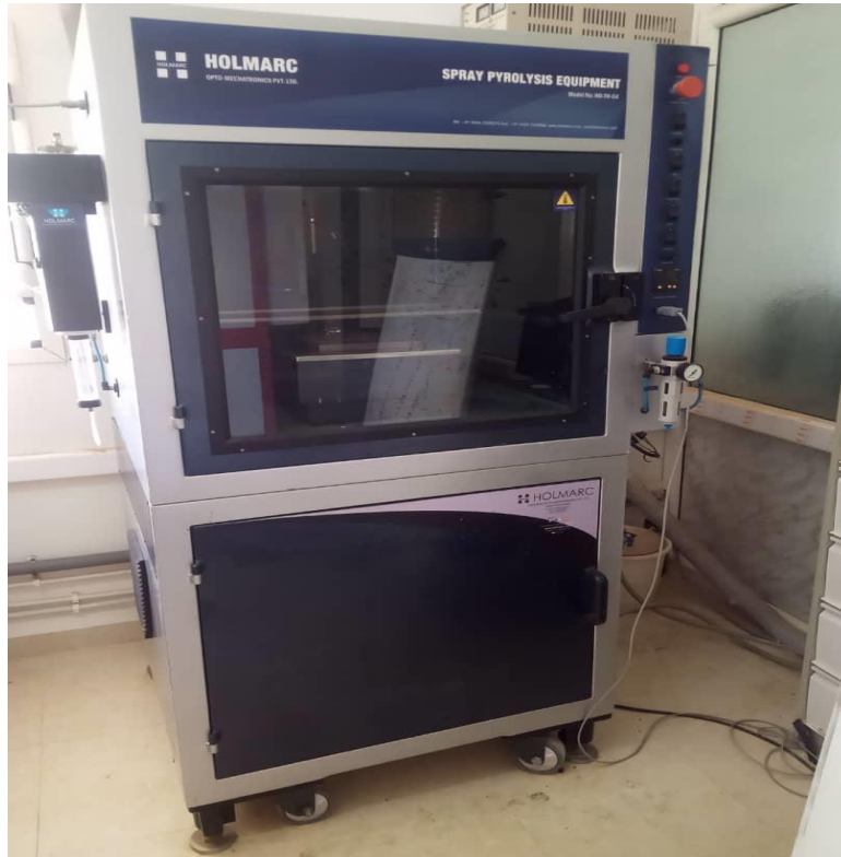
الشكل (II-8): جهاز رش الإنحلال الحراري المستعمل في التجريب.
