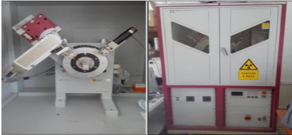
الشكل (II-16): جهاز إنعراج الأشعة السينية (DRX) [53].
