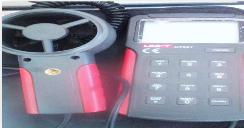
Figure III.6: appareil de mesure de température ambiante et la vitesse de vent.
