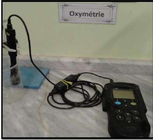
الصورة (8): جهاز قياس الأوكسجين المنحل
