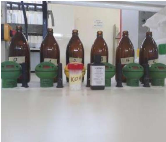
الصورة (10): الأدوات المستعملة في قياس  $DBO_5$
