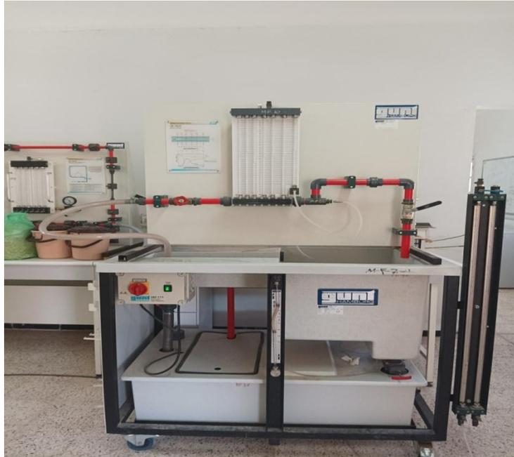
شكل (2-3): صورة تبين التجربة الأولى (الجهاز الأساسي فوق جهاز التغذية بالماء
