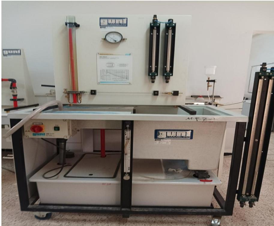
شكل (3-4): صورة تبين التجربة الثالثة (الجهاز الأساسي فوق جهاز التغذية بالماء)
