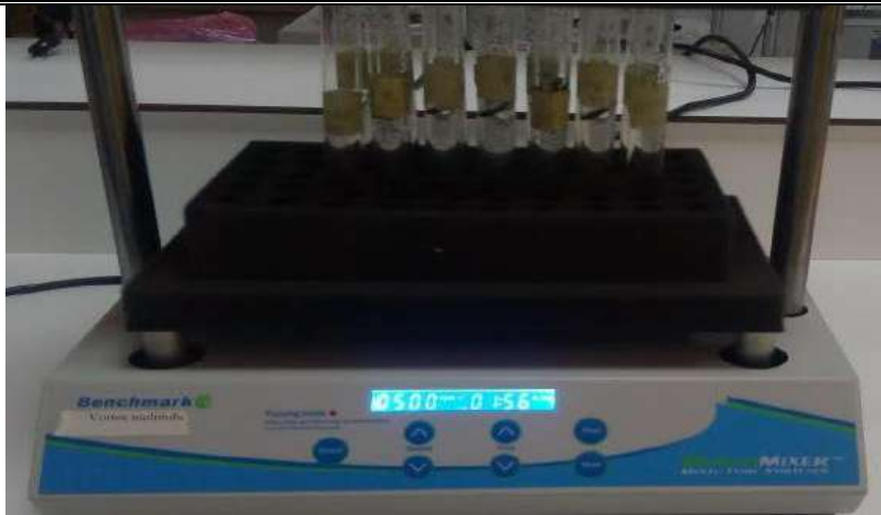
Figure II. 6.1 : Phénomène d'adsorption (méthode de batch) par Vortex multitube
