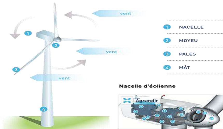
Figure.I.17. Composants d'une éolienne [I.50]
