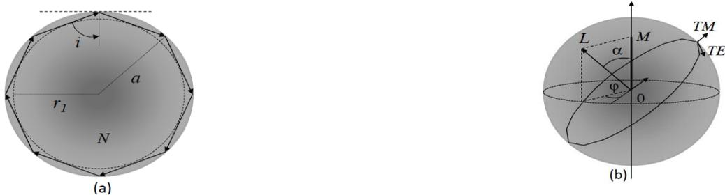
Figure II.3 (a) propagation du rayon lumineux par RIT dans un résonateur de rayon  $R$  et d'indice  $N$  (approximation de l'optique géométrique). (b) Moment angulaire  $L$  associé au WGM avec sa projection  $M$  sur l'axe polaire. TE, TM désignent ses polarisations
