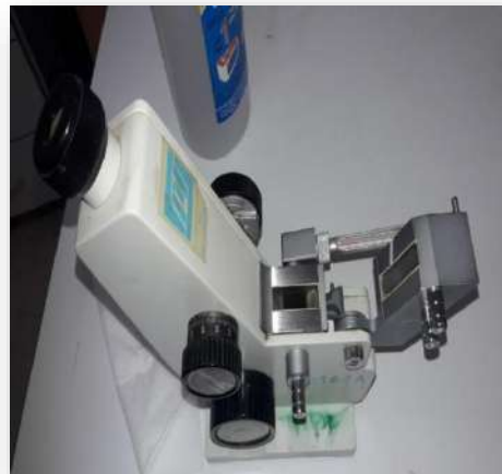
Fig II.06: Montage de mesure de l'indice de réfraction (photo originale)
