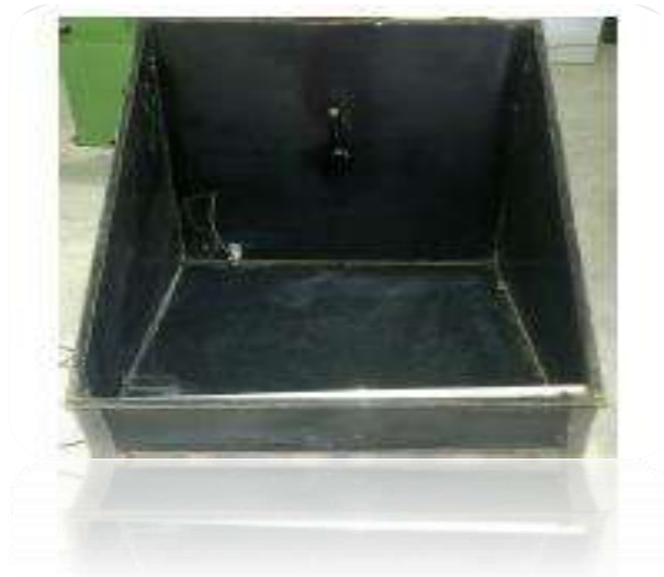
FigII.3 le corps galvanisé du conventionnel alambic solaire
