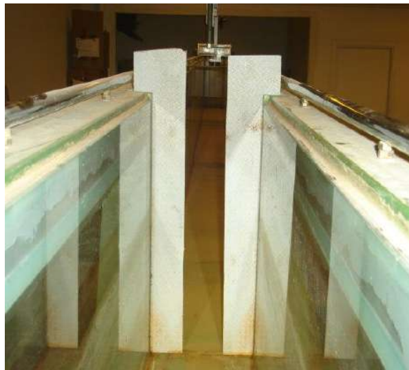
Photo 1.8 : Photographie du déversoir rectangulaire mesurant les débits
