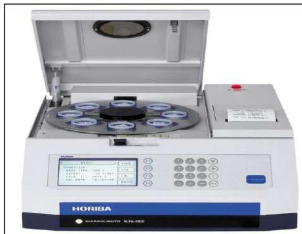
**Figure I.13:** Appareil de détermination de la teneur en soufre par fluorescence rayon X. Type : HORIBA, Référence : SULFUR-in-OIL ANALYSER SLFA-2800.
