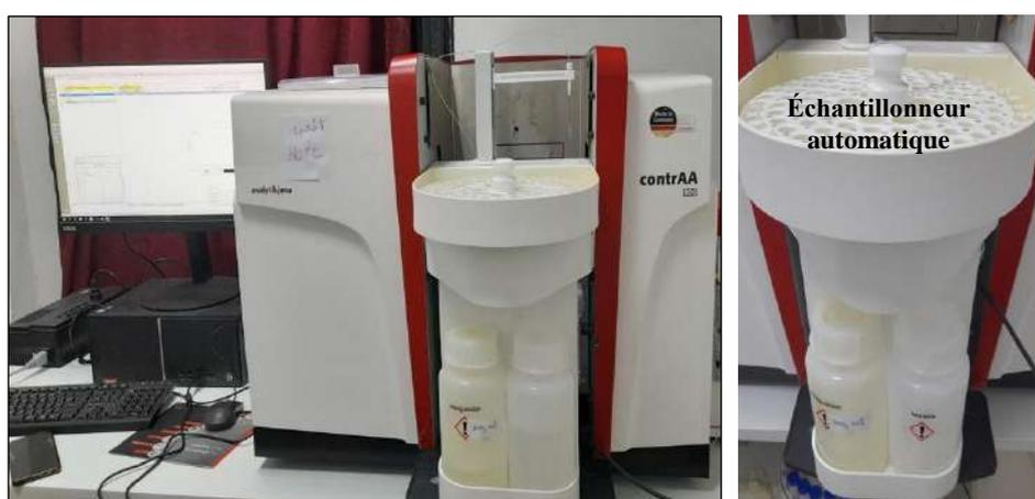
*Figure II.3 : Appareil de spectrométrie d'adsorption atomique REF de l'appareil contrAA® 800 D.*
