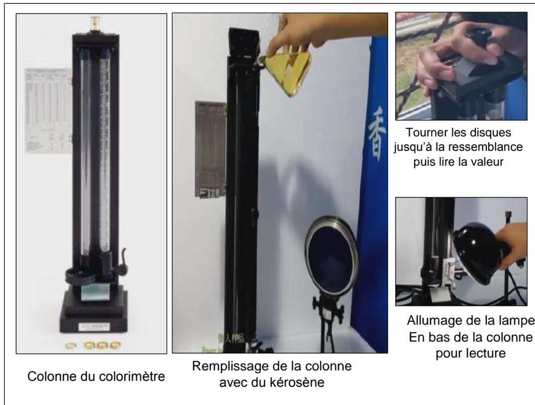
**Figure I.16:** Mesure de la couleur du gasoil à l'aide d'un colorimètre union.
