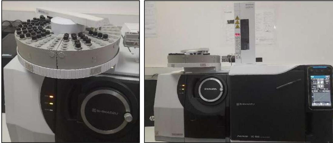
*Figure II.2: Appareil de chromatographie en phase gazeuse couplée à la spectrométrie de masse Référence de l'appareil (Nexis GC-2030).*
