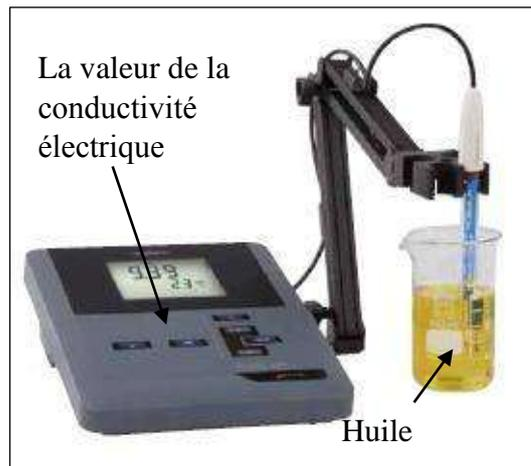
**Figure I.12:** Mesure directe de la conductivité électrique à l'aide d'un conductimètre.
