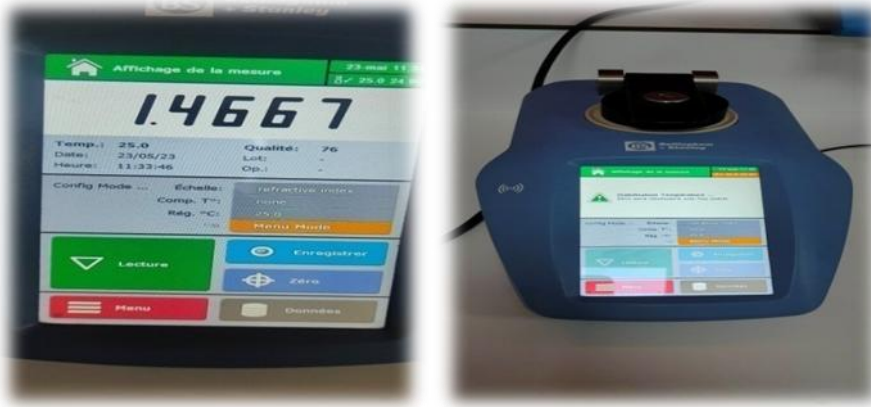
الشكل (IV-11):جهاز قياس قرينة الانكسار Réfractomètre
