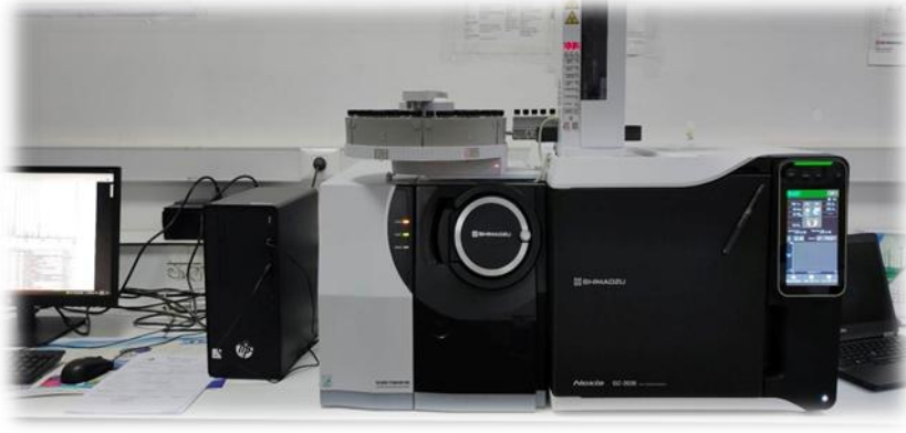
الشكل (13-IV): جهاز كروماتوغرافيا الغازية المرفقة بمطيافية الكتلة GCMS
