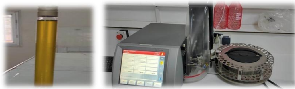
الشكل (IV-12): جهاز قياس الكثافة واللزوجة Viscometer SVM™ 3001
