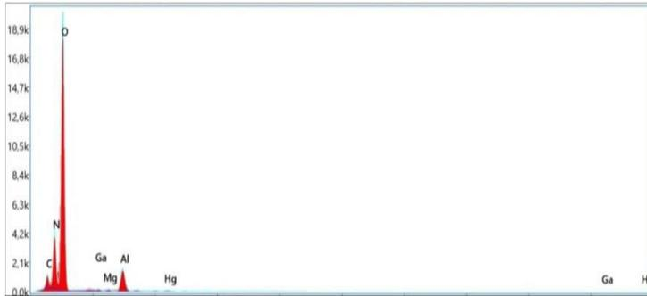
الشكل (04- V): طيف تشتت الطاقة بالأشعة السينية للعينة (Sol/gel(10ml).
