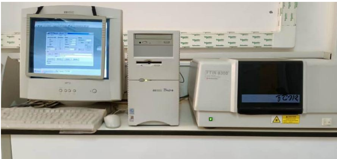
الشكل 12. جهاز مطياف الأشعة تحت الحمراء.
