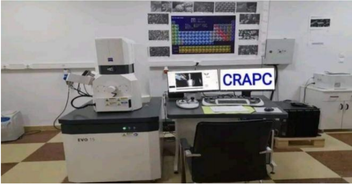
الشكل 11. 18 :جهاز المجهر الإلكتروني الماسح
