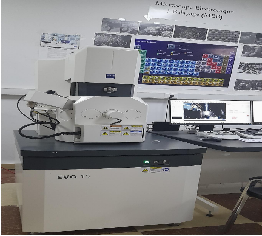
الشكل (II-5): صورة جهاز المجهر الإلكتروني الماسح (MEB)
