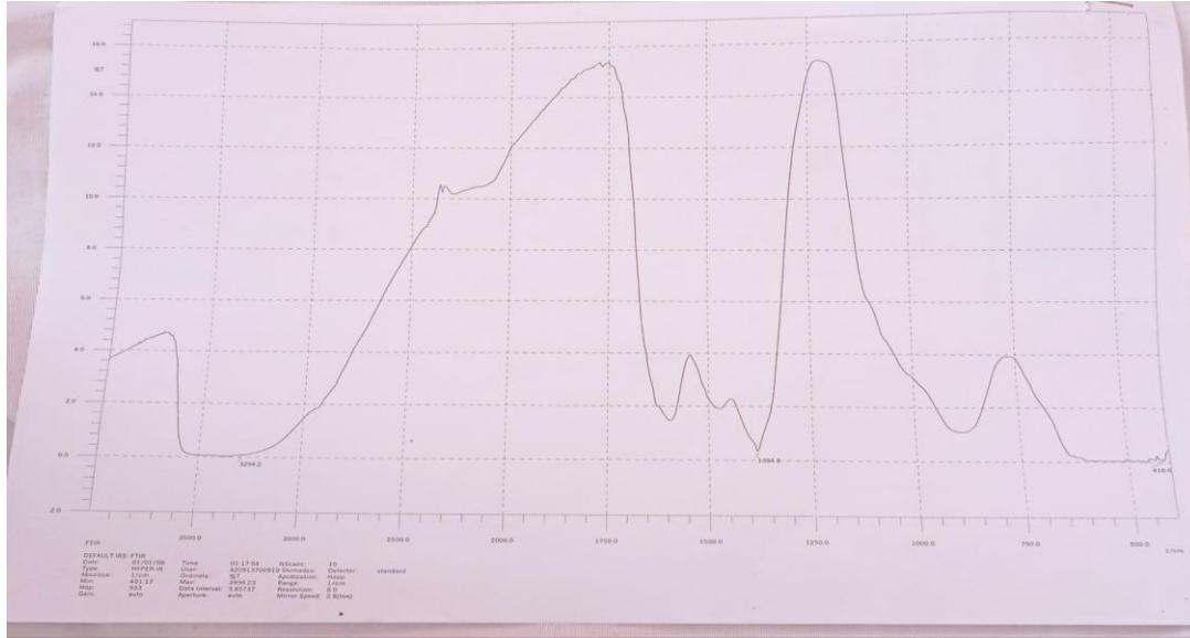
الشكل(4-IV): يمثل طيف الامتصاص للأشعة تحت الحمراء(FTIR) للمركب CuO-ZnO NPs
