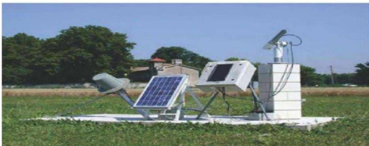
شكل (II-9): جهاز (SUN_PHITOMETRE) المستخدم في شبكة AERONET. [16]
