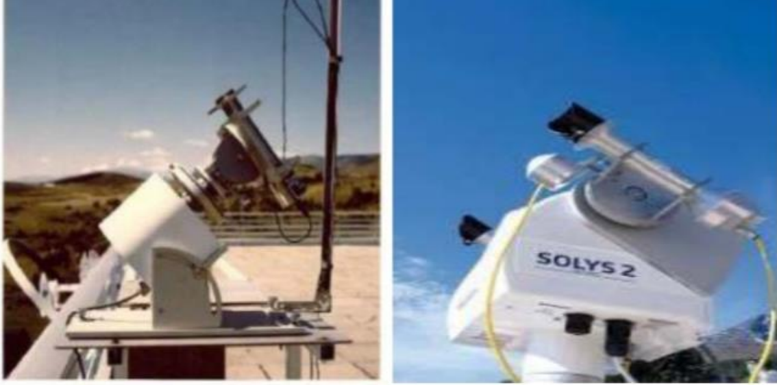
الشكل (9-I): جهاز البيروهليومتر[12].
