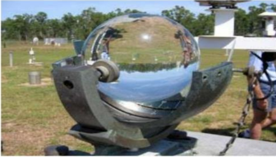
الشكل ( I- 10 ):جهاز كامبل ستوكس [12].
