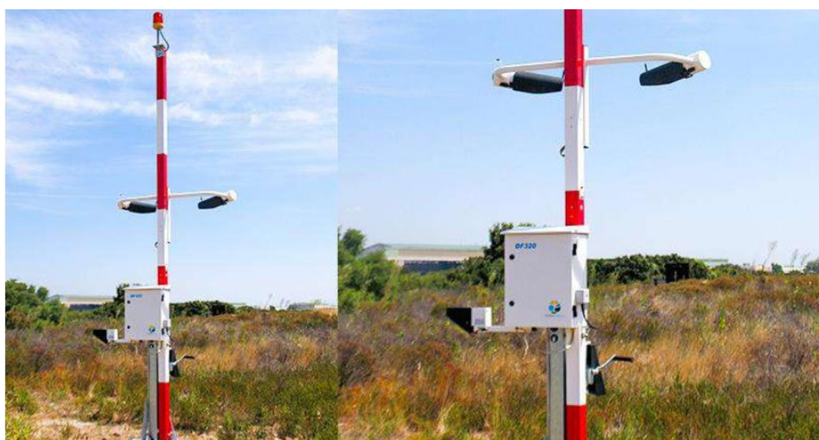
(شكل II-12): مقياس DF320 الرؤية لشركة Degreane-Horizons [20]
