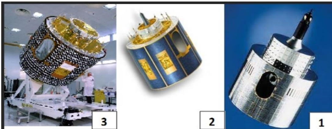
الشكل (II-17): صور القمر الصناعي متيوسات (1) الجيل الأول (2) الجيل الثاني (3) الجيل الثالث [25].
