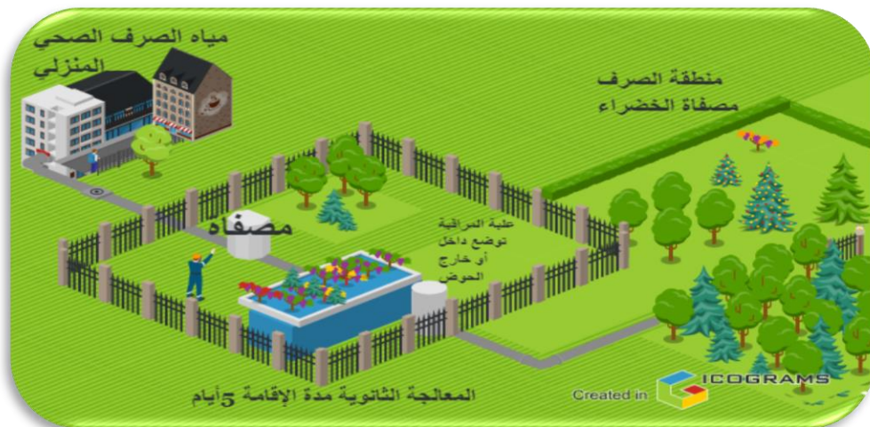
الشكل رقم (10.III): يمثل مخطط مراحل المعالجة في المحطة
