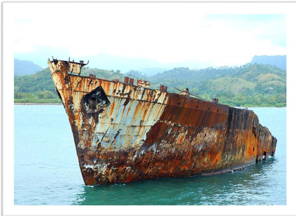
الشكل -1-I- صورة التآكل
