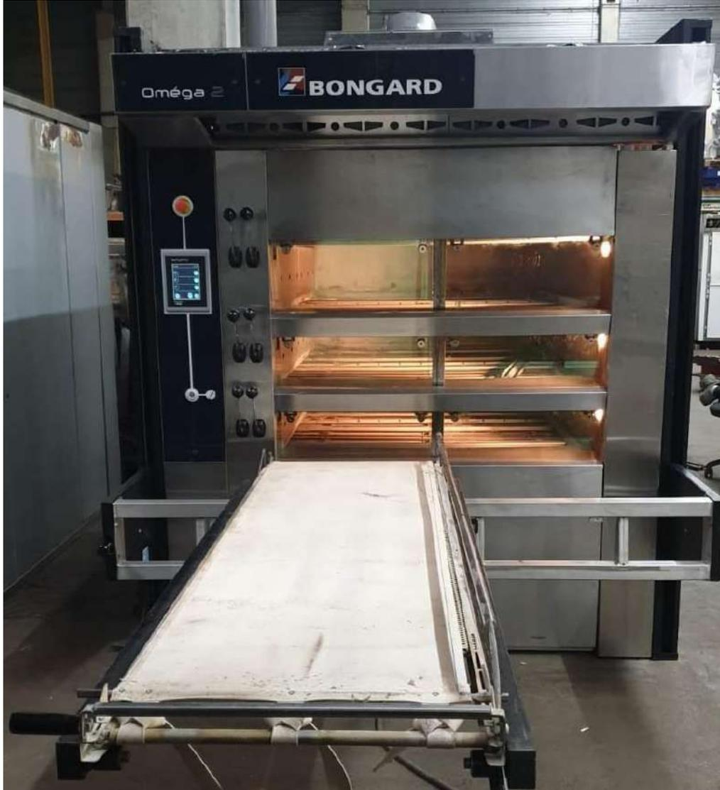
**Figure II-1** : Un four de cuisson à l'échelle industrielle typique
