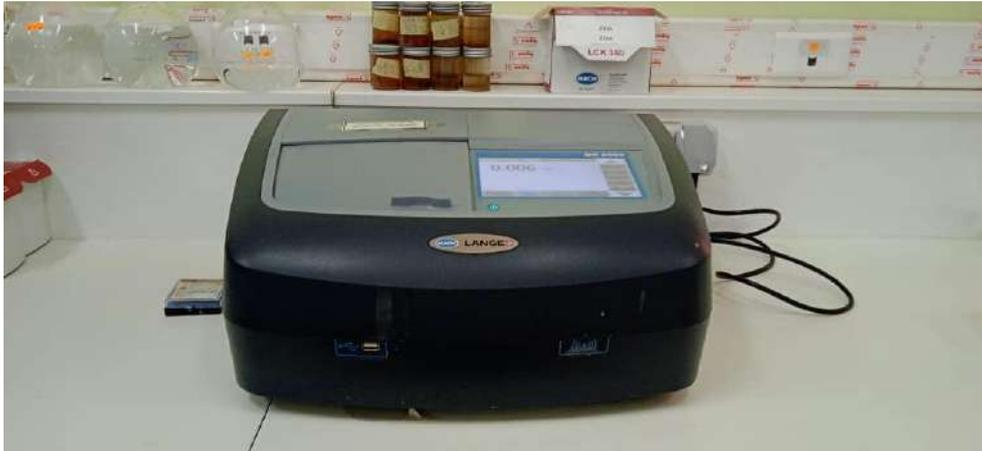
Figure III-3 Spectrophotomètre UV- visible utilisé
