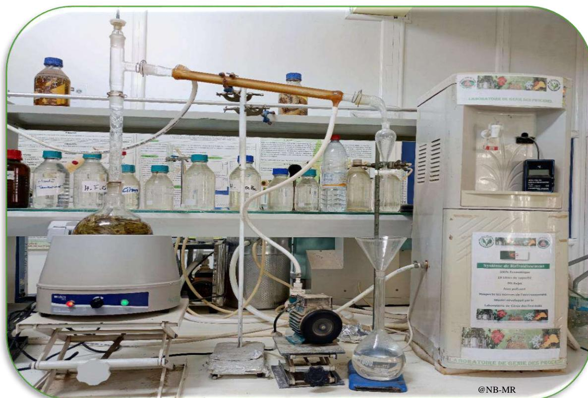
Figure IV.4 : Montage d'hydrodistillation LGP-UKMO (photos originales)
