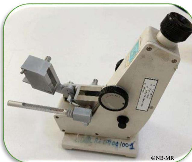
**Figure IV.9 :** Réfractomètre Abbé de Carl Zeiss
