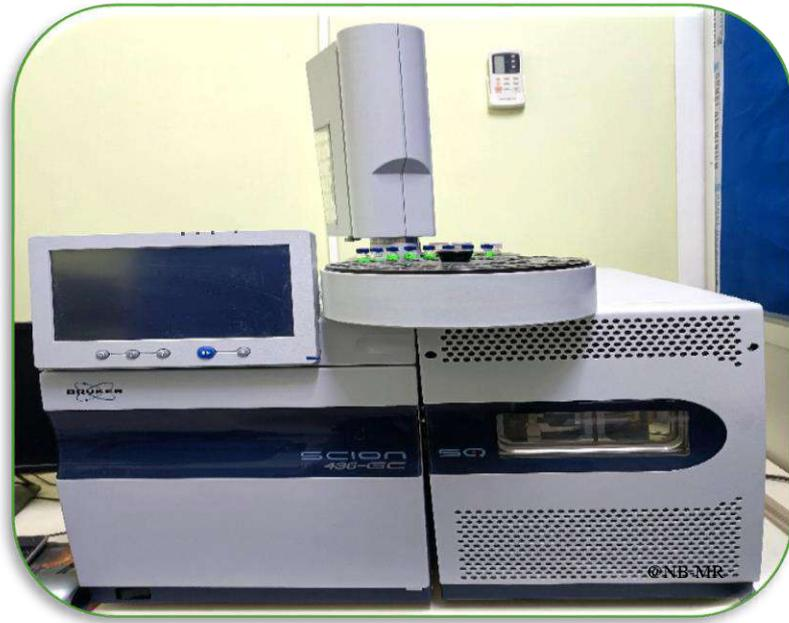
**Figure IV.14 :** Appareil de chromatographie en phase gazeuse couplé à la spectrométrie de masse GC/MS – LGP/UKMO
