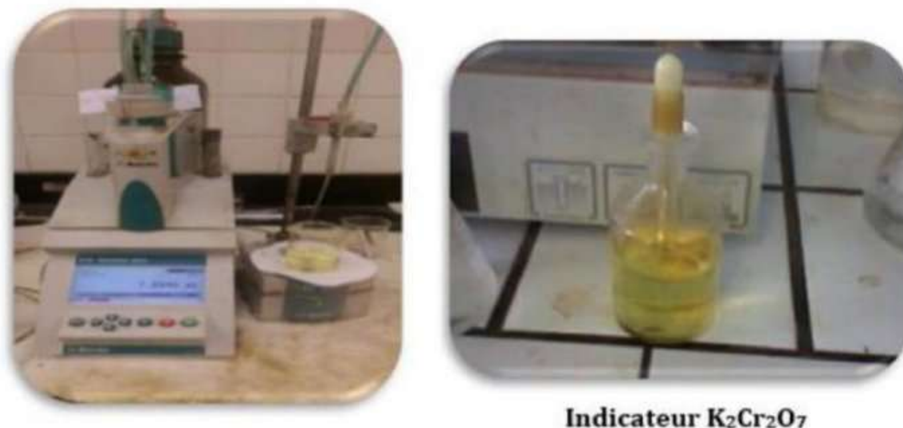
Figure IV.4 : Titrage de l'eau minérale
